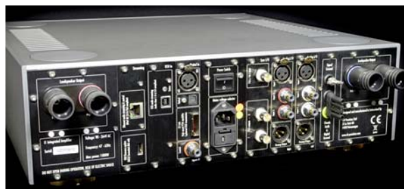
Anschlussfeld des CH Precision I1 (bei Vollausstattung)
